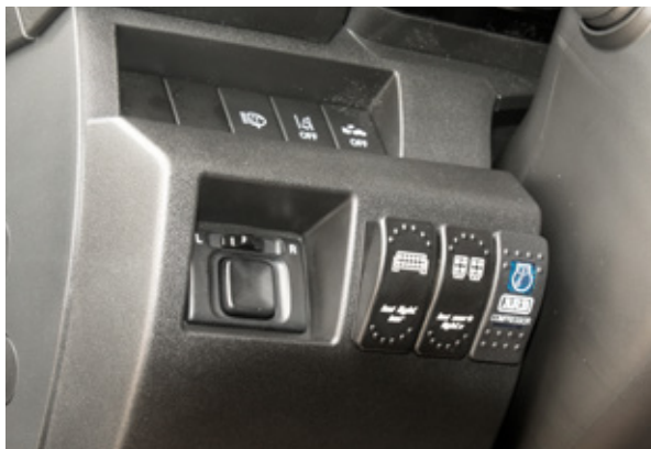
An einem Fleck geschaltet: zweimal Licht, einmal ARB-Kompressor.
