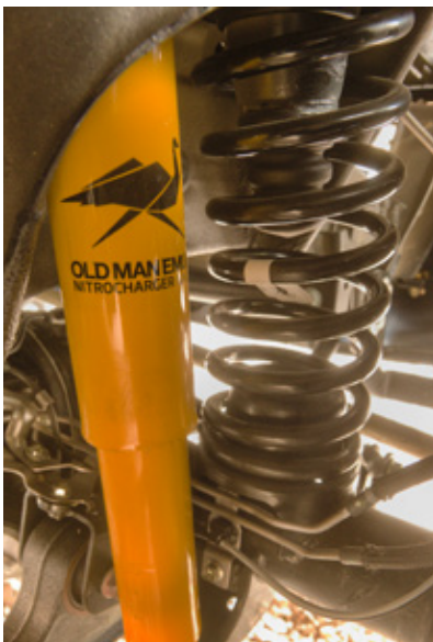
Hoch, aber komfortabel: Das 50-Millimeter-Fahrwerk von OME verschränkt ordentlich.
