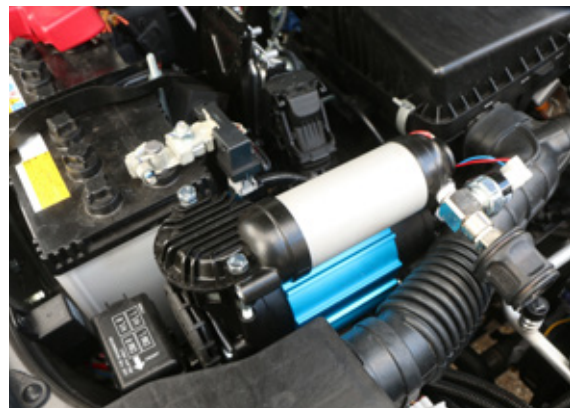
Gut integriert: der Kompressor mit Füllanschluss im Motorraum.
